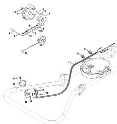
Система зажигания, Выключатель останова
