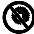
Bruk aldri sirkelsagblad, hardmetall-, bergings-, treskjærings- eller annet tannet verktøy – **fare for dødelige skader!** I motsetning til bruk av kappeskiver, der partiklene tas jevnt av, kan tennene på et ryddesagblad hekte seg fast i materialet under skjæring. Dette gir aggressive skjæreforhold, og kan føre til ukontrollerte og svært farlige reaksjoner (tilbakeslag) fra kappeslipemaskinen.
