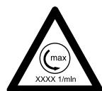
Допустимое число оборотов абразивно-отрезного круга должно быть равным максимальному числу оборотов шпинделя абразивно-отрезного устройства или превышать его! – см. главу "Технические характеристики".
