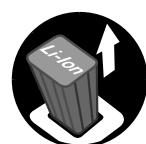
Ta batteriet ut av kappeslipemaskinen:
