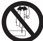
Brusno paraču ploču uvesti ravno u rezni raspored, ne zarubljivati i ne izlagati postranom opterećenju.
