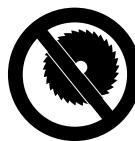
Nikada ne upotrebljavati listove kružne pile, oštice od tvrdog metala, oštice za spasavanje, oštice za drvo ili druge ozubčane alate – **opasnost od smrtonosnih povreda!** Nasuprot ravnomjernom skidanju čestica pri korišćenju brusno paračih ploča, zubi nekog lista kružne pile mogu se pri rezanju zaglaviti u materijalu. To uzrokuje agresivno vladanje pri rezanju i može izazvati nekontrolirane, izuzetno opasne sile reakcije (odbacivanje u vis) brusnog parača.
