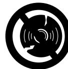
češće provjeravati brusno paraču ploču – odmah zamijeniti, ako se pokažu pukotine, ispučenja/nabori ili druga oštećenja (na primjer pregrijavanje) – uslijed loma postoji **opasnost od nesreće!**
