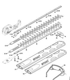
Режущее устройство HSE 61
