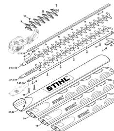
Режущее устройство HSE 81
