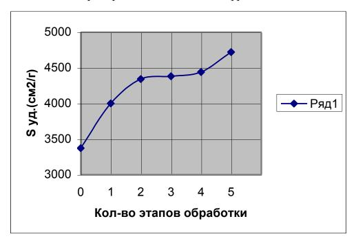
Анализ кривых распределения частиц цемента по фракциям при изменении времени обработки лежалого цемента показал, что увеличение количества этапов обработки приводит к смещению кривых распределения в сторону увеличения количества мелких фракций цемента. Так, для необработанного цемента количество частиц диаметром менее 20 мкм составило 54,6%, а для цемента обработанного 5 раз составило 71,2%.
