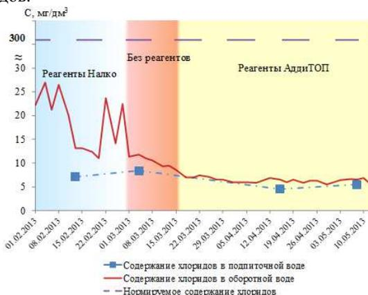
Рисунок 2 – Изменение содержания хлоридов в водах ВОУ №627 в период опытного пробега.
