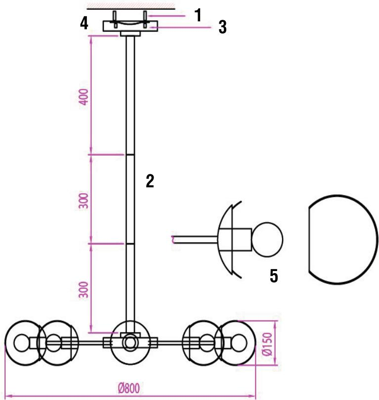
1. Просверлить ударной дрелью отверстия для пластиковых дюбелей. Вставить пластиковые дюбели в просверленные отверстия. Привернуть с помощью саморезов крепежную планку.
