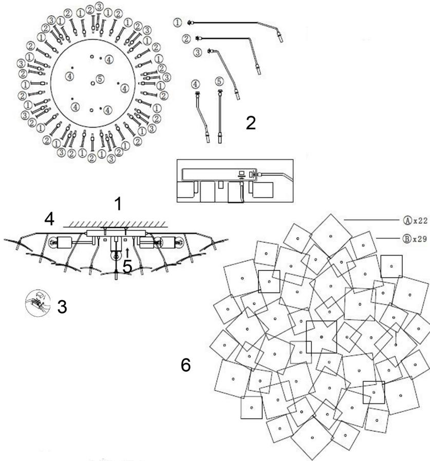
1. Просверлить ударной дрелью в потолке отверстия для пластиковых дюбелей. Вставить пластиковые дюбели в просверленные отверстия. Привернуть с помощью саморезов крепежную планку.
