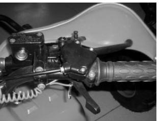
Рис. 7 – рычаг переднего тормоза
