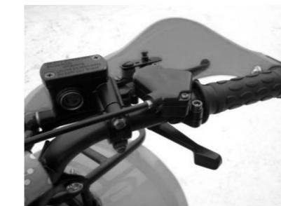
Рис. 6 – рычаг управления дросселем
