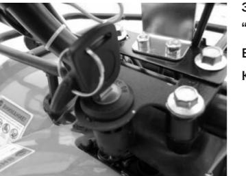
Рис. 3 – замок зажигания
