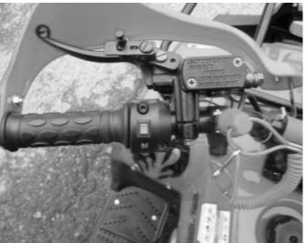
Рис. 8 – рычаг заднего тормоза
