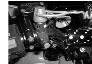
Рис. 5 – аварийный выключатель двигателя
