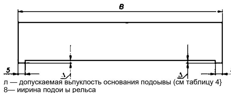
Рисунок Ж16 — Шаблон контроля выпуклости основания подои вы
