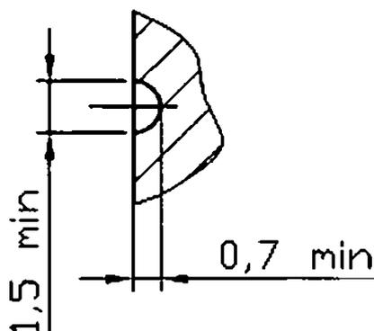
\* Размеры указаны с учетом высоты швов от разъема матриц, наплывов металла в углах подголовка и заусенцев от обесчечки облоя.
