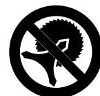
Защитное приспособление не использовать с ножами для молодняка и пильными полотнами.
