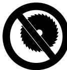
Запрещается применять пильные диски, твердосплавные, спасательные, дереворежущие или иные зубчатые инструменты – **опасность получения смертельной травмы!** В противоположность равномерному съему частиц при эксплуатации абразивно-отрезных дисков, зубья пильного диска с долотообразными зубьями при резке могут застрять в материале. Это способствует агрессивной резке, что может привести к возникновению неконтролируемых, чрезвычайно опасных реактивных сил (обратный удар) агрегата.
