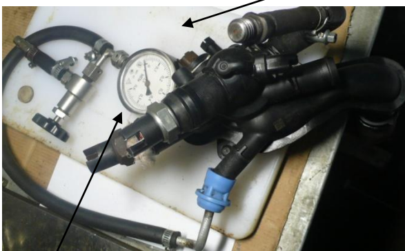
термостат закреплен на плите
