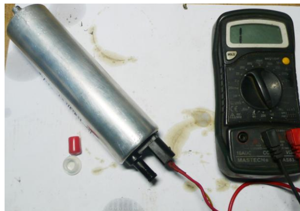
проверка цепи обмотки насоса
