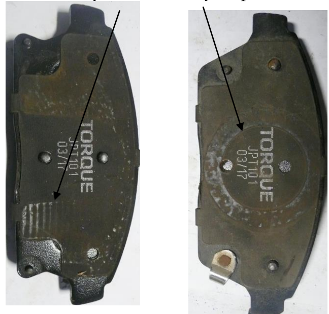
следы установки в суппорт
