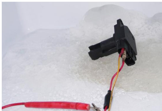
датчик в морозильной камере показания пирометра показания мультиметра
