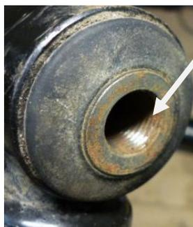
следы воздействия резьбы
