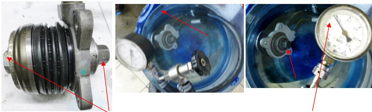
*подшипник стянут болтом, стэнд опрессовки, при давлении 2.0 бар воздух не из корпуса подшипника не выходит.*
