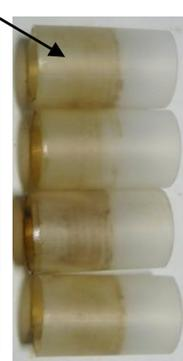
Проведенным исследованием установлено, что «Свечи зажигания Nickel», произв. DENSO, кат. номер: K20PRU11, 4 шт. исправны, загрязнены отложениями. «Недостаток», заявленный покупателем – не связан с качеством изготовления деталей, а вызван неудовлетворительной работой двигателя автомобиля.
