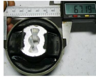
*Измерения в нагруженном (сжатом) состоянии в перпендикулярных плоскостях.*
