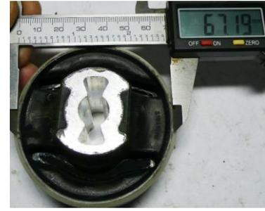
*Измерения в нагруженном (сжатом) состоянии в перпендикулярных плоскостях.*
