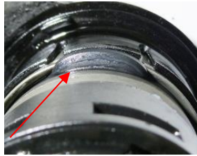
повреждения уплотнительной манжеты
