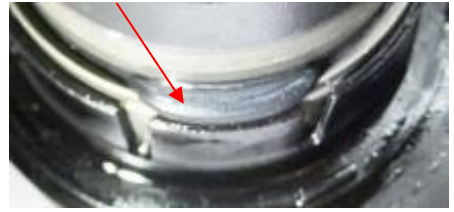
повреждения уплотнительной манжеты
