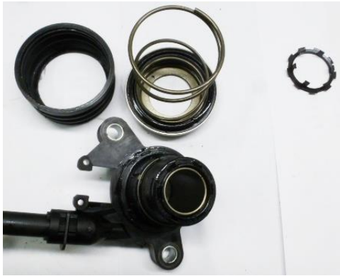
повреждения уплотнительной манжеты
