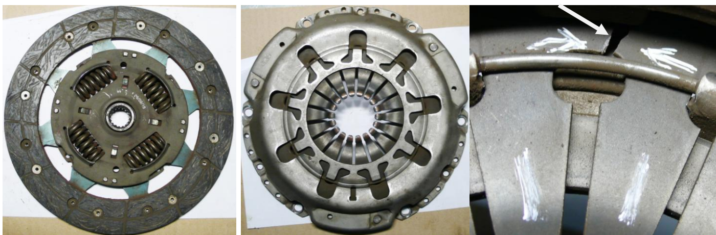
следы от болтов крепления нажимного диска к маховику на чашке диска
