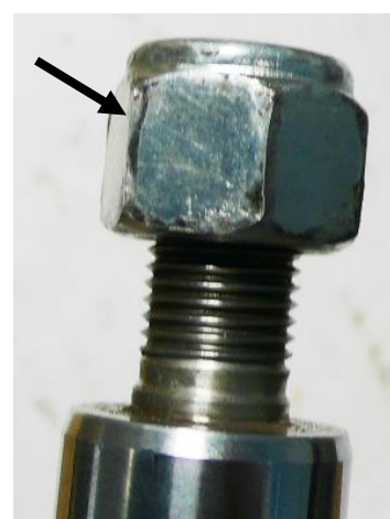
повреждение ребер гайки
