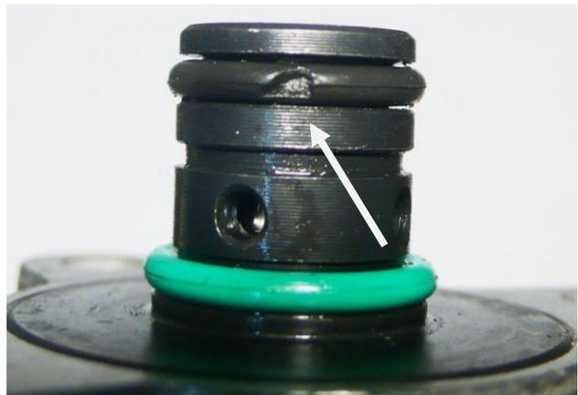
Проведенной проверкой качества установлено, что «Клапан», произв. LEDO, кат. номер: 80014LSPF – исправен. Повреждено одно из уплотнительных резиновых колец при неизвестных эксперту обстоятельствах, наиболее вероятно – при установке детали в автосервисе на автомобиль.
