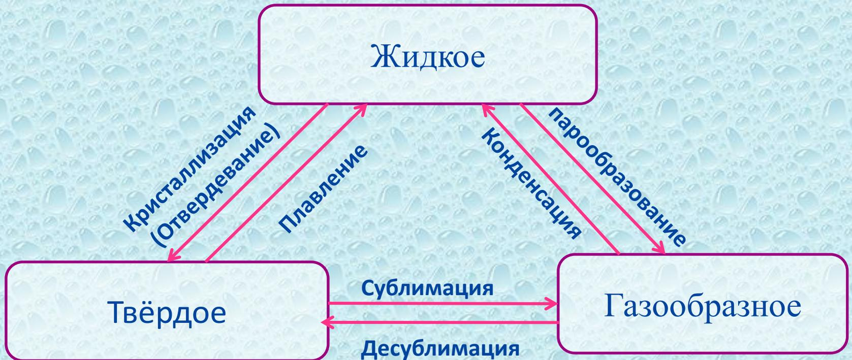
Процесс перехода вещества из твердого состояния в жидкое называется плавлением. Оно идет с поглощением тепла и увеличением внутренней энергии.
