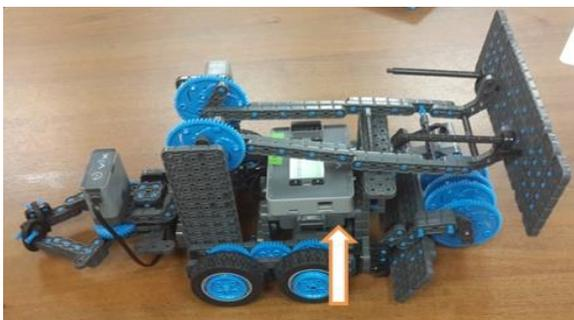
•Радио: модуль управления VEXIQ передает сигналы управления устройством с помощью радио волн или кабеля;
