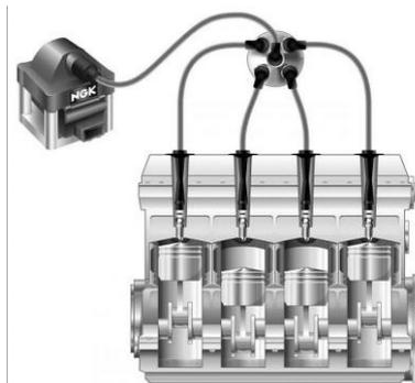
(Рис2.3) Система зажигания ДВС
