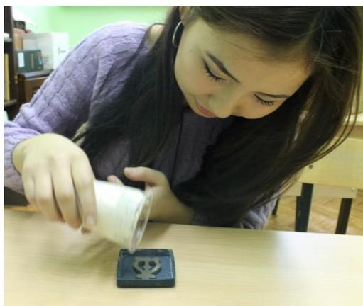
4. После затвердения гипса вынимаем пластилин и даем высохнуть форме.
