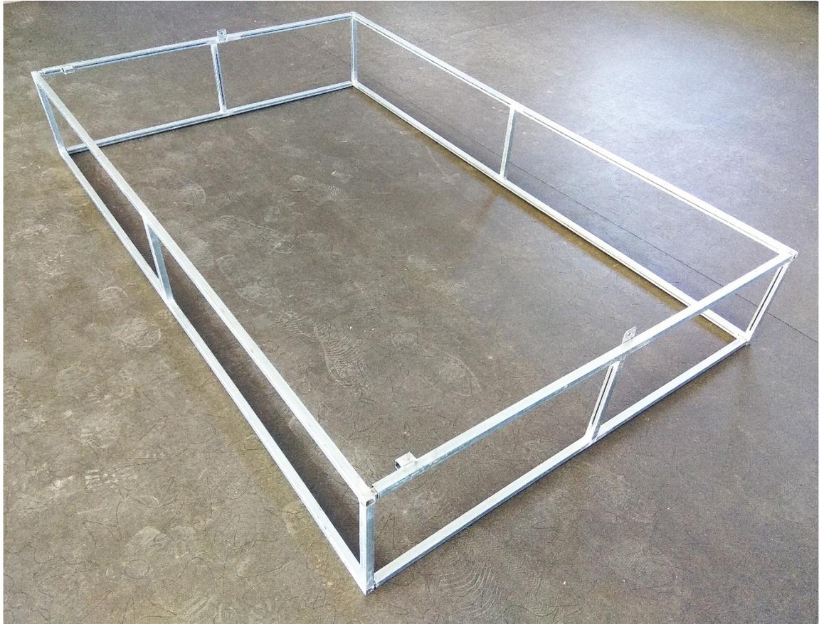
3. Сборка фрамуг внешней и внутренней (соединение труба-в-трубу)
