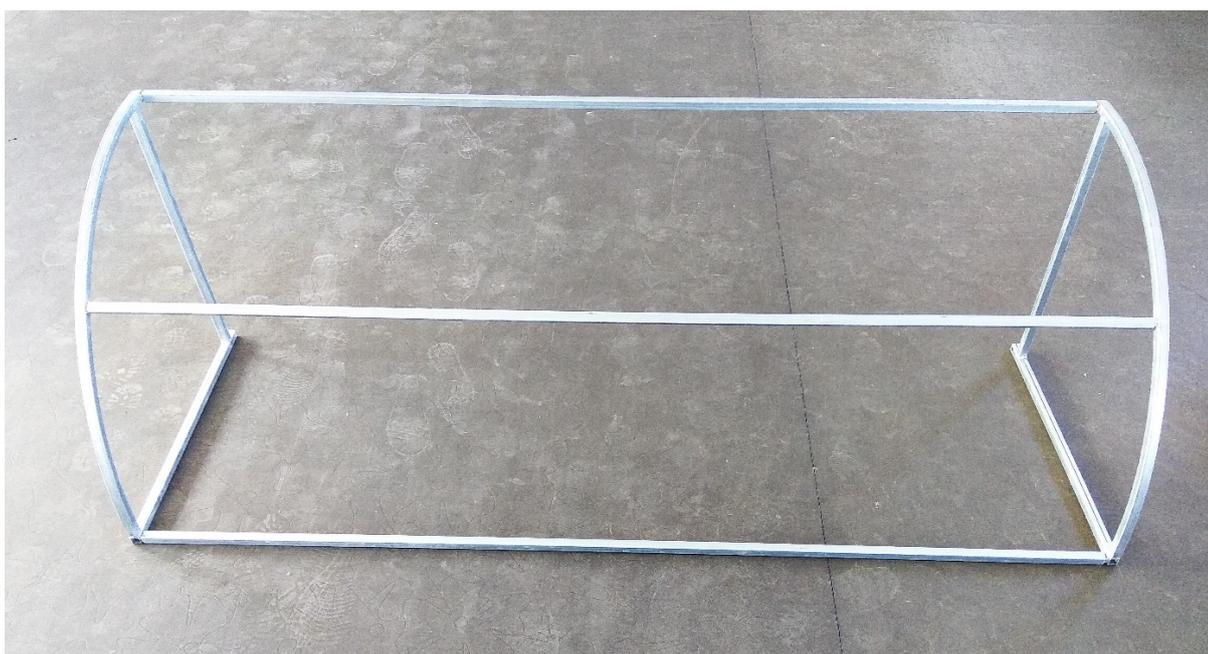
4. Закрепление всех соединений саморезами:
