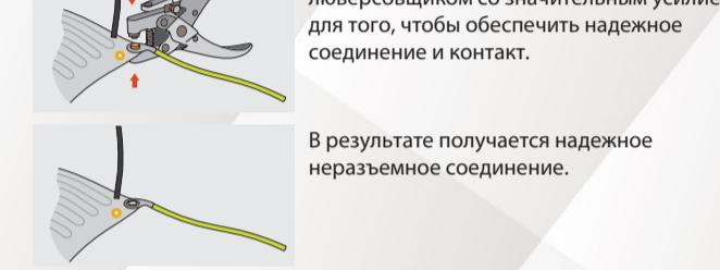
Обожмите эту конструкцию люверсовщиком со значительным усилием для того, чтобы обеспечить надежное соединение и контакт.
