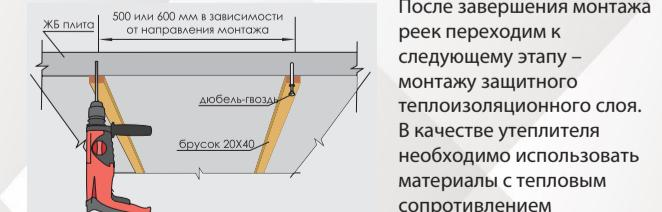
После завершения монтажа реек переходим к следующему этапу – монтажу защитного теплоизоляционного слоя. В качестве утеплителя необходимо использовать материалы с тепловым сопротивлением не менее 0,2 м² °C/Wt.
