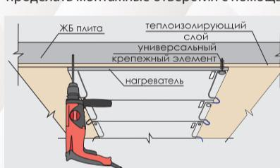
Монтаж лент нагревателей и теплоизоляции на перекрытия из дерева (фанеры) осуществляется аналогично способу крепления на деревянные рейки. Монтаж на ГКЛ, ГВЛ, ОСП, СМЛ,
