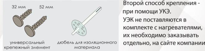
При помощи перфоратора, буром диаметром 7,0 мм просверлите сквозь теплоизоляцию отверстие и при помощи большого пальца руки или основания ладони протолкните до упора УКЭ и прижмите теплоизоляцию к потолочной поверхности.
