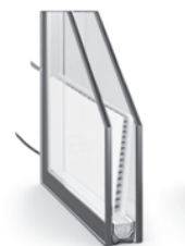
Рис. 1. Расположение элемента Пельтье в воздушном пространстве окна
