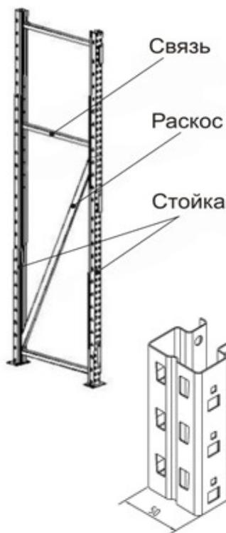
■ **Рама стеллажа** представляет собой несущую ферменную конструкцию из двух перфорированных несущих стоек, соединенных между собой горизонтальными и диагональными связями при помощи болтовых соединений.
