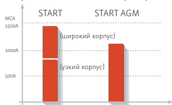
START & START AGM Сила тока холодной прокрутки морских двигателей в Амперах при 0°*
