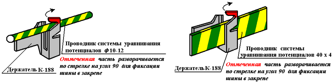
Рисунок 7.5 - Способ крепления проводников заземления и системы уравнивания потенциалов при помощи держателей К - 188
