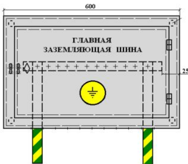
Рисунок 7.1 - Ящик главной заземляющей шины.
