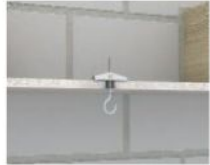
Пружинно-откидной и откидной дюбель Вследствие распрямления боковых лапок создается поверхность прилегания на пластине. Путем поворота резьбы крючок приводится в правильное положение и фиксируется гайкой.
