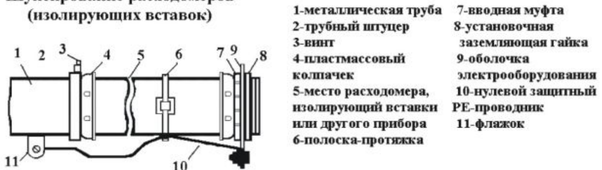
Рисунок 7.9 - Шунтирование расходомеров, задвижек.
