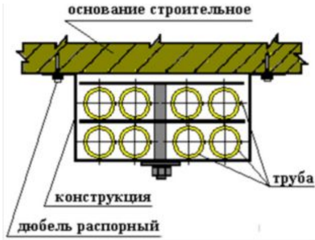
Рисунок 4.4.11 Крепление пластмассовых труб с применением электромонтажной конструкции к строительному основанию с помощью распорного дюбеля
