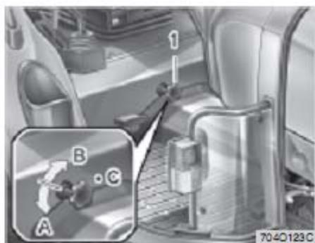
1 – Рукоятка регулировки скорости снижения 3-точечной сцепки
