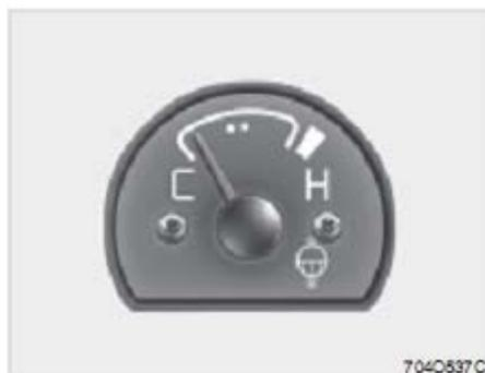
(1) датчик температуры охлаждающей жидкости
