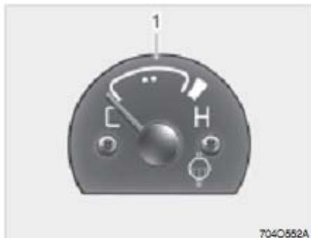
(1) датчик температуры охлаждающей жидкости
