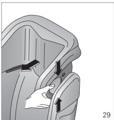
Ryggstödet, som kan ställas in i djupled ger ett säkert läge när barnet sover, eftersom det sovande barnets huvud inte kan falla framåt och lämna nackstödets skyddande område. För optimal säkerhet sätts den inställbara luftkudden i normalläget "full" (15-20 Manövrering av handpumpen).
