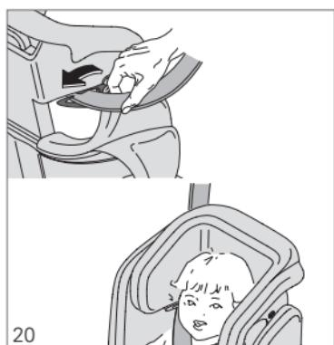
Legen Sie anschließend den Diagonalgurt in die Gurtführung an der Kopfstütze. Der Schultergurt darf hierbei aus Sicht des Kindes nur nach hinten führen! Gegebenenfalls den Sitz nur auf der Rücksitzbank benutzen.
