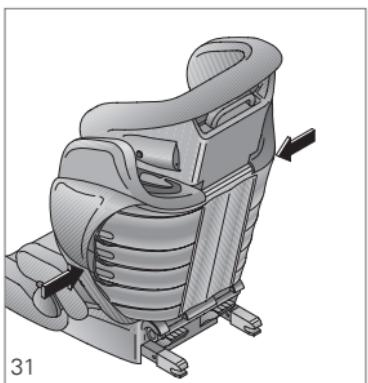
Die seitlichen Verstärkungsrippen verbessern zusammen mit dem Bezug den Schutz Ihres Kindes bei einem Seitenauftreff und ermöglichen eine komfortable Hinterlüftung der gesamten Rückenlehne.
