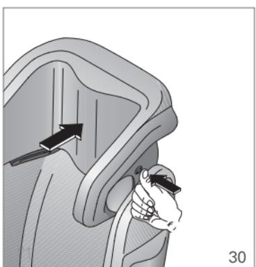
Durch Drücken des Auslassventils kann die Ruheposition für den Kopf stufenlos eingestellt werden. Das Herauslassen der Luft kann durch Druck auf das Luftkissen beschleunigt werden. Für eine aufrechtere Position pumpen Sie das Luftkissen wie oben gezeigt wieder auf.
