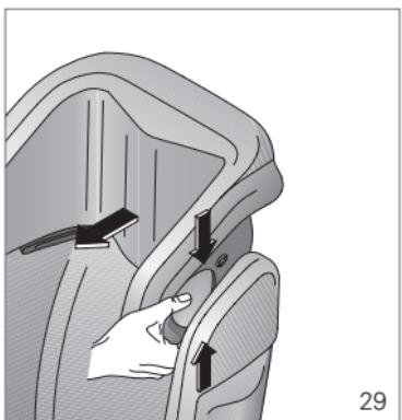
Die stufenlos in der Tiefe verstellbare Kopfstütze sorgt für eine sichere Schlafposition des Kindes, da der Kopf des schlafenden Kindes nicht nach vorne fällt und den schützenden Kopfstützenbereich verlässt. Bringen Sie das verstellbare Luftkissen in den Normalzustand „voll“ für optimale Sicherheit (15 - 20 Betätigungen der Handpumpe).
