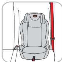
Setzen Sie Ihr Kind in den **HEYNER® MultiRelax AERO Fix** Kindersitz. Lassen Sie nun den Schultergurt des Fahrzeuges durch den Gurtbandführungsschlitz laufen. Um einen optimalen Gurtverlauf zu gewährleisten, sollte der Schultergurt in der Mitte der Schulter entlanglaufen.
