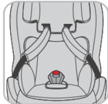
Соедините язычки замка безопасности (С) плечевых ремней (G2) и вставьте их в замок ремней безопасности (D). Ремень застегнут правильно, если Вы услышали "щелчок".
