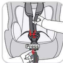
Теперь протяните поясную часть ремня безопасности (W), включая язычок замка ремня безопасности (V), над подлокотниками автокресла и вставьте язычок замка. Вы услышите "щелчок", если замок закрыт.
