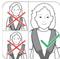
ребенка, Вы теперь можете отрегулировать подголовник по высоте таким образом, чтобы ремни безопасности находились на уровне плеч ребенка. После выставления подголовника на нужную Вам высоту, отпустите кнопку механизма регулировки подголовника по высоте (H). Механизм фиксации зафиксирует выбранную высоту подголовника.
