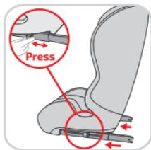
Протяните ремень TOP-TETHER над автокреслом. Для того, чтобы разблокировать замки (**IK**) ISO-FIX-коннекторов (**IM**), чуть прижмите автокресло **HEYNER® MultiRelax AERO Fix** к сидению автомобиля и нажмите на кнопку регулировки ISO-FIX-коннекторов (**IE**) по длине.
