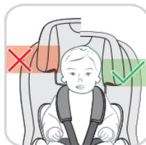
Для того, чтобы отрегулировать высоту подголовника (А) в соответствии с ростом и весом ребенка, возьмитесь за подголовник сверху и потяните за кнопку механизма регулировки подголовника по высоте (Н). В соответствии с ростом и весом
