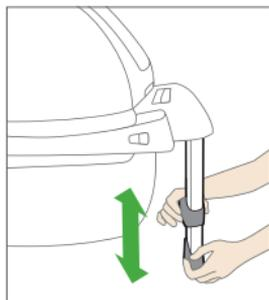
Zum Einstellen der Stützfußhöhe betätigen Sie die Verriegelung an der Vorderseite des Stützfußes und ziehen Sie den Stützfuß bis zur benötigten Länge aus. Achten Sie darauf, dass der Stützfuß einrastet.
