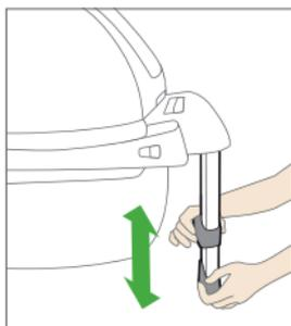
Для регулировки высоты опорной ножки нажимайте на фиксатор на передней стороне опорной ножки и выдвиньте опорную ножку на нужную длину. Проследите, чтобы опорная ножка зафиксировалась.
