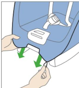
Pour retirer la housse de la partie inférieure de l'assise, défaire les nœuds de fixation de la housse situés sur le devant de la coque. Mettez la coque le plus en avant possible pour vous faciliter la tâche.
