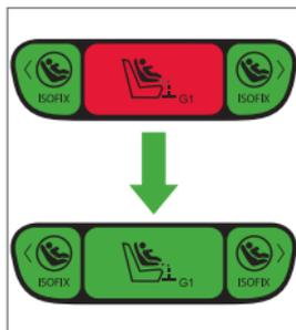
När längden är korrekt inställd ändras stödbenets indikering till grönt meddetsamma du ställer stödbenet på bilgolvet. Om den inte gör det ska du dra fram stödbenet ytterligare så som beskrivs ovan.
