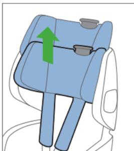
Verschieben Sie nun die Kopfstütze in die gewünschte Position und lassen Sie die Verriegelung einrasten.
