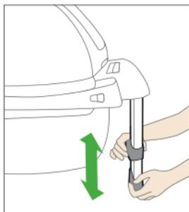
Pour régler la hauteur de la jambe de force, actionnez le verrouillage sur l'avant du pied et tirez-le jusqu'à la longueur requise. Veillez à ce que de la jambe s'enclenche.
