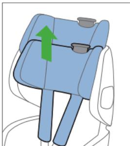
Placez l'appui-tête à la hauteur souhaitée et enclenchez le dispositif de verrouillage.
