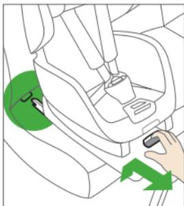
Для выдвижения фиксаторов Isofix нажмите ручку в центре и вытяните фиксаторы до упора.
