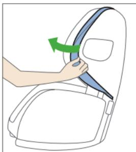
Ομυζ desteği kılıfını çıkarmak için kılıfı yan yivden çekin ve öne doğru çıkarın.
