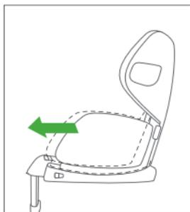
Un déplacement de la coque vers l'avant permet d'obtenir une position de repos.
