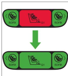
Ved en korrekt indstillet længde skifter visningen for støttefoden til grøn, så snart du stiller støttefoden på bunden af bilen. Hvis det ikke er tilfældet, skal du køre støttefoden lidt længere ud, som beskrevet foroven.
