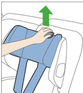
Для отпущения фиксатора надо потянуть вверх рычаг на задней стенке.
