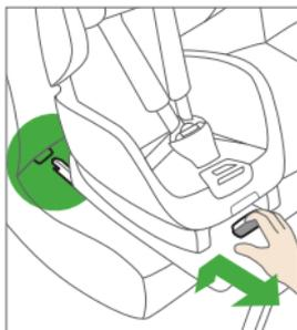
Para extender los conectores Isofix, accione la manecilla central situada en la parte delantera y tire de los conectores hasta que hagan tope.
