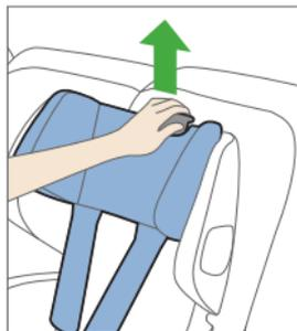
Para soltar el enclavamiento, tire de la palanca del lado posterior hacia arriba.
