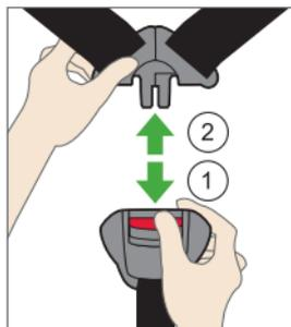
Öffnen Sie das Gurtschloss durch Druck auf die rote Taste (1) und ziehen Sie die Schloßzungen (2) nach oben heraus.
