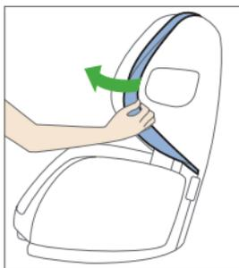
Para sacar la funda del soporte para el hombro, tire de la funda por la ranura lateral y sáquela hacia delante.
