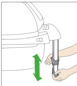
Za nastavitve višine odporne noge pritisnite zapah na sprednji strani noge in nogo izvlecite do potrebne dolžine. Bodite pozorni na to, da se oporna noga zaskoči.
