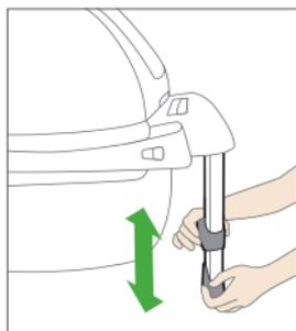
Para ajustar la altura del pie de soporte, accione el enclavamiento del lado delantero del mismo y tire del pie de soporte hasta alcanzar la longitud necesaria. Asegúrese de que el pie de soporte encaje.
