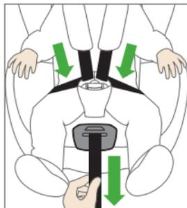
Straffen Sie den Gurt durch Ziehen am Verstellgurt. Je straffer der Gurt an Ihrem Kind anliegt, desto sicherer ist es in der Optiafix aufgehoben. Es ist deshalb zu empfehlen dicke Jacken oder Pullover im Fahrzeug auszuziehen.
