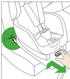
Pour sortir les connecteurs Isofix, actionnez la poignée centrale située sur l'avant et tirez les connecteurs dans la mesure du possible.
