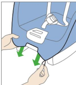
Alt oturma parçası kılıfını çıkarmak için koltuk yuvasının alt kenarından kavrayın ve sabitleme halkalarını kancadan çıkarın. Koltuk yuvasını en ön pozisyona getirirseniz işlem daha kolay yapılır.
