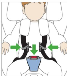
Una las hebillas de cierre e insértelas en el dispositivo de cierre del cinturón. Deje que encajen de forma audible.
