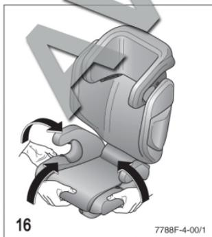
Вытяните нижние пластиковые планки из соответствующих прорезей. Снимите чехол снаружи, начиная с направляющих ремня. Сами направляющие при этом демонтировать нельзя.
