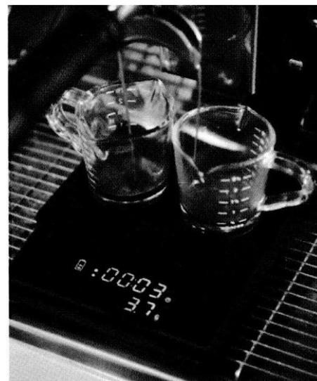
(1) Нажмите и удерживайте кнопку питания в течение 1 сек, чтобы изменить режим работы весов, на экране отобразится символ ⦿, указывающий на то, что весы находятся в режиме эспрессо.
