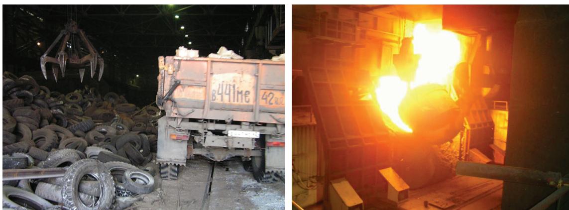
Рис. 18.6. Переработка отработанных автомобильных покрышек в кислородных конвертерах Западно-Сибирского металлургического комбината
