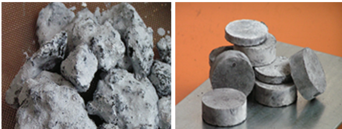
Рис. 18.5. Кусковые и брикетированные синтетические легкоплавкие флюсы на основе фторуглеродистых отходов алюминиевого производства
