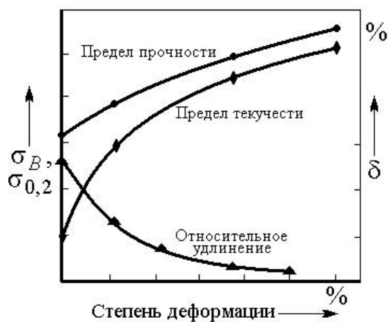
Рис. 1.20. Характер изменения свойств после холодной пластической деформации металлов
