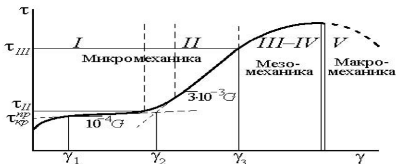
Рис. 1.19. Вид кривой «напряжение – деформация» и соответствующие масштабные уровни деформационного упрочнения
