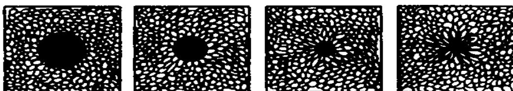
Рис. 4.5. Залечивание поры в режиме вязкого течения
