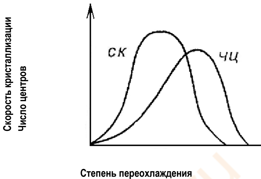
Рис. 1.19. Параметры кристаллизации в зависимости от степени переохлаждения
