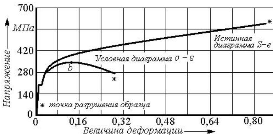
Рис. 1.2. Общий вид условной \sigma - \varepsilon и истинной S - e диаграмм деформации для низкоуглеродистой стали
