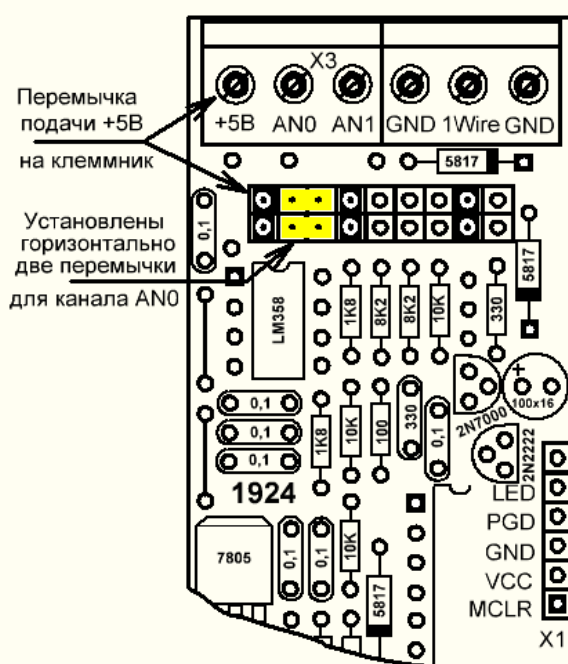
Канал AN1 настроен на подключение стандартных датчиков, канал AN0 на подключение высокоомных датчиков
