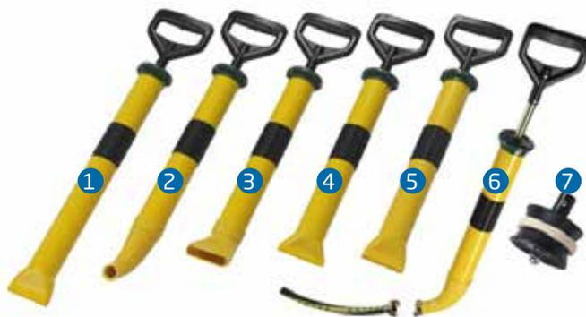
Для равномерного и быстрого заполнения штробы анкеро-ровочным составом применяются ручные насосы. Сопло насоса погрузить в емкость с готовым к применению составом, заполнить камеру насоса, потянув рукоятку насоса на себя. Подавать материал в штробу обратным движением поршня нажатием на рукоятку.
