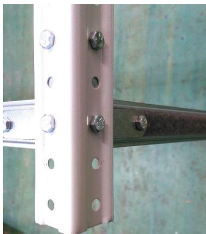
4. Соединить болтами среднюю полку с четырьмя стойками, совместно с уголками жесткости, разместив их с внешней стороны полки между полкой и стойкой (24 болта, 24 шайбы, 24 гайки на полку), не затягивая гаек. Если средних полок нет в комплектации, то переходите к п.5.
