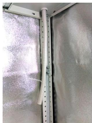
5. Используя пластиковые хомуты, закрепите гофротрубки к стойкам гроутента-стеллажа
