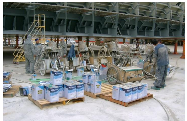
Балластный танк - финальный слой (Покраска завершена)
