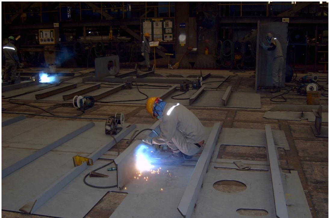
Фабрикация частей блоков. (Ручной режим)
