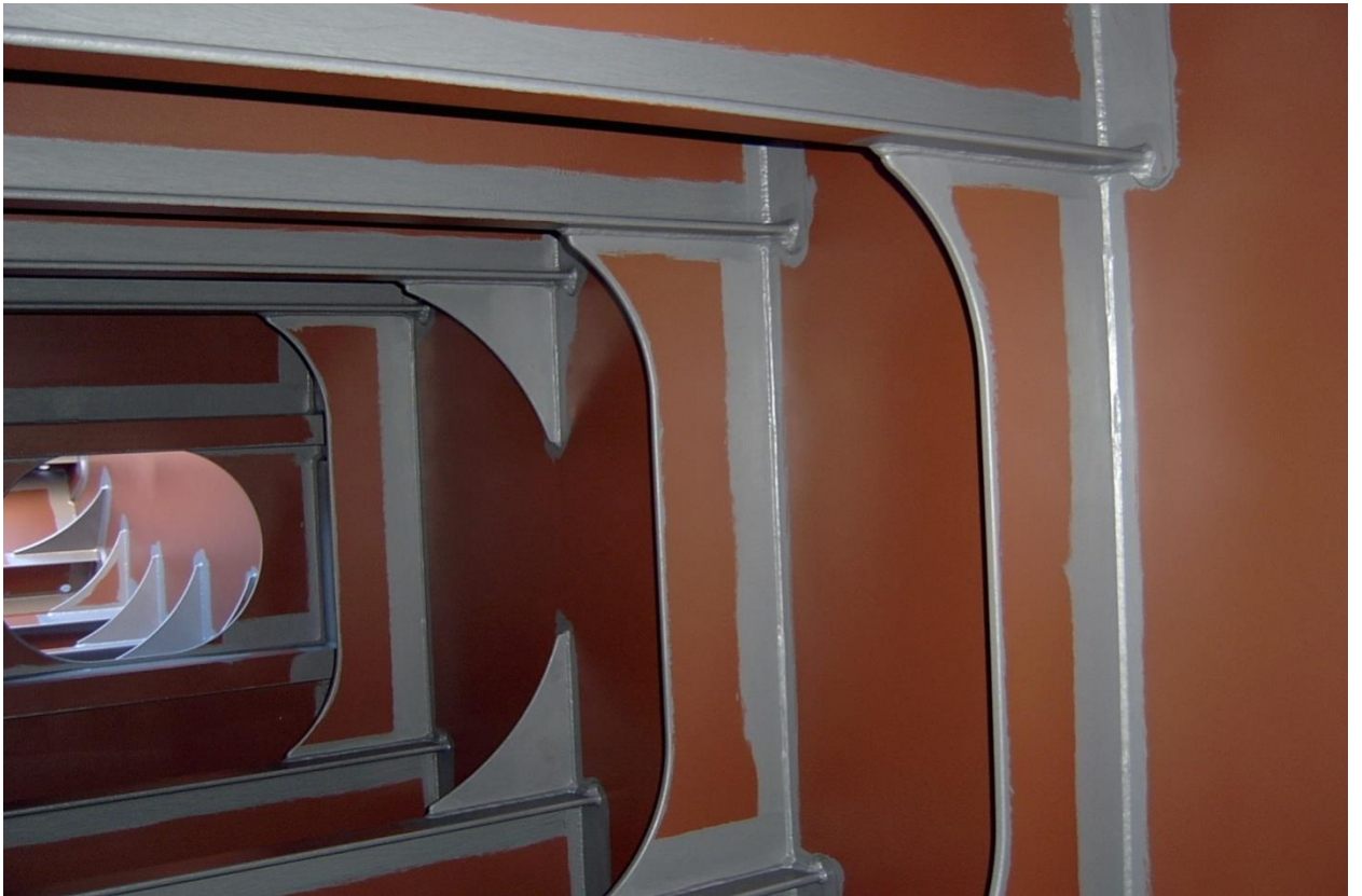
Днищевой блок - район балластного танка - нанесен первый слой и проведена линейная окраска
