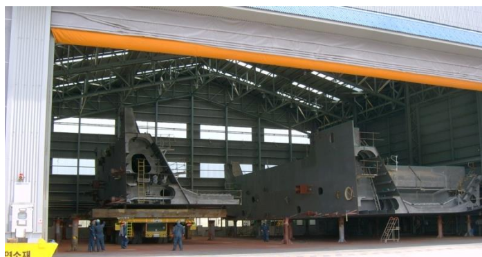
Бортовые блоки в покрасочном цехе, после очистки
