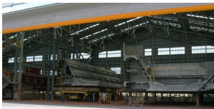
Бортовые блоки в покрасочном цехе, после очистки
