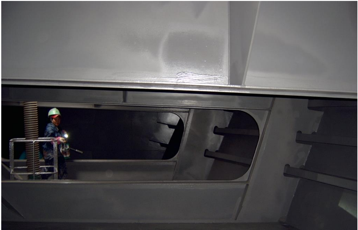
Балластный танк - финальный слой (Покраска завершена)
