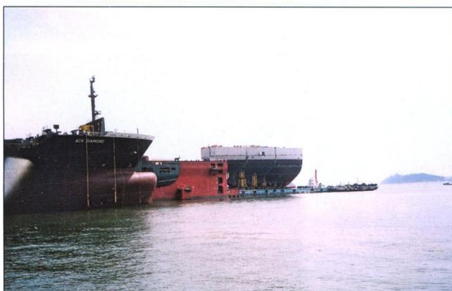
Giga-блок перемещается в плавдок с баржи-площадки на колесных транспортерах
