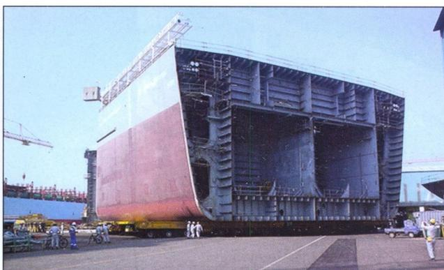
Giga-блок перемещается на сборочную площадку с помощью колесных транспортеров
