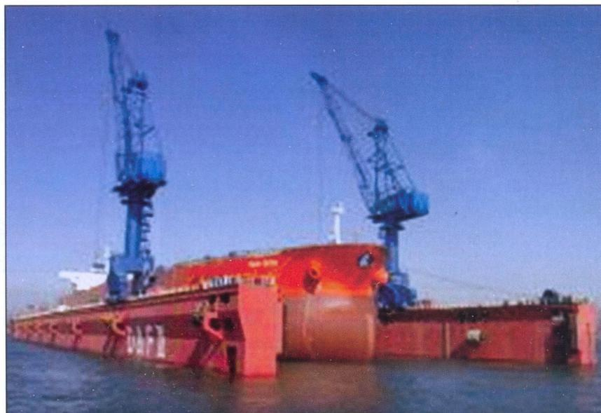
Спуск судна по схеме «причал—плавдок»
