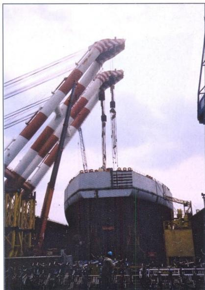
Сборка судна в плавдоке
