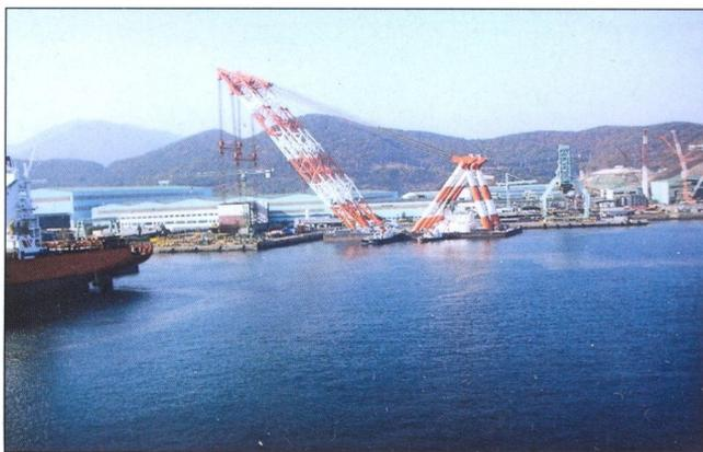
Использование мощного плавкрана для подачи блока на сборку
