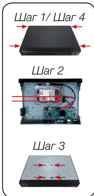
Рис. 2 Установка HDD.
